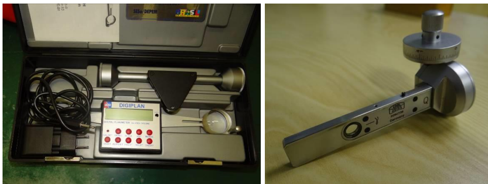
Figura 3: Planímetro. Mede a área em uma carta/mapa. Fabricante Digiplan. (Esq.). Dreh Kompensator Quartz, placa compensadora de quartzo para microscópio. Fabricada por Carl Zeiss (Dir.)
