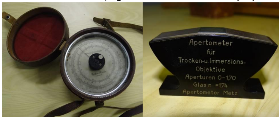
Figura 1: Barômetro altímetro de nivelamento, fabricado na Suécia por System Paulin Aktiebolag Stockholm (Esq.). Apertômetro de Abbe, utilizado para medir a abertura numérica da objetiva de um microscópio. Fabricado po Ernst Leitz Wetzlar. Esse objeto pertenceu à antiga Faculdade Nacional de Filosofia, registrado sob número F.N.F. 7742 (Dir.)
