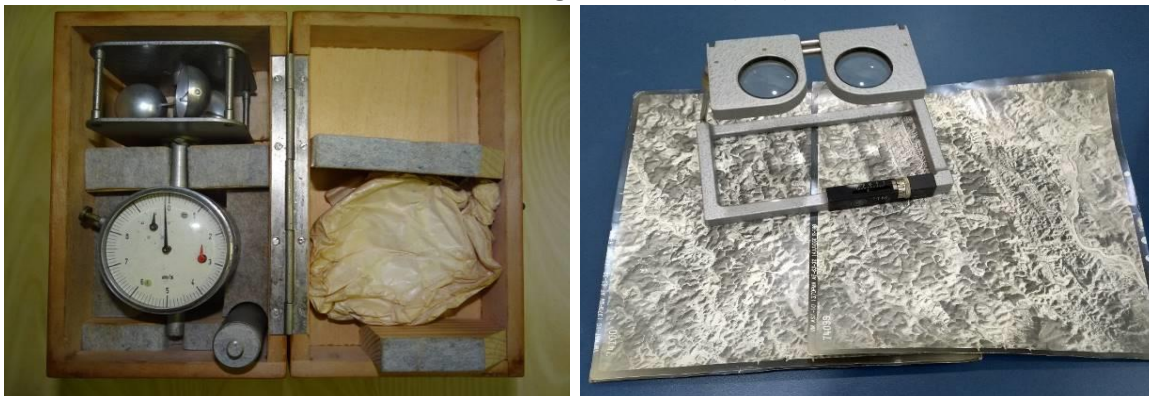
Figura 2: Anemômetro, utilizado para medir a velocidade e direção do vento. Fabricado por ASCA "S/A", Rio de Janeiro-São Paulo (Esq.). Esteroscópio de lente com micrômetro. Utilizado para análise de fotografias aéreas (Dir.)
